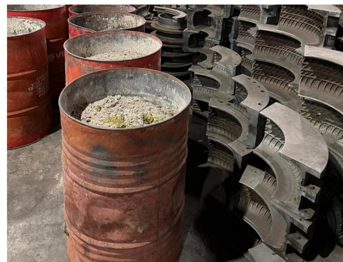
Moldes para fabricação dos pneus
